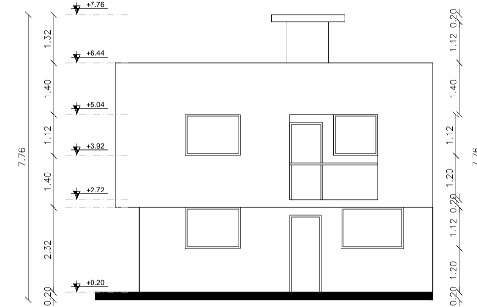
FACHADA LATERAL DERECHA ESC 1:100
